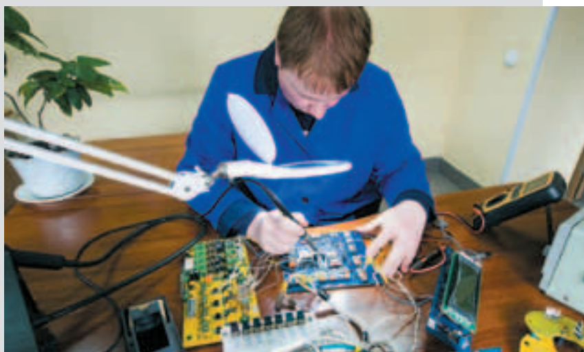
Дмитрий Алгайкин за ремонтом электронных плат дизельных локомотивов
