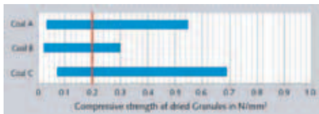
Рис. 3. Предел прочности на сжатие гранул различного типа углей
